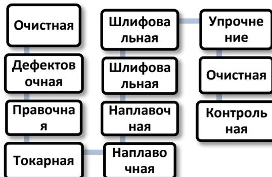
Рис. 1. Схема ремонта коленчатого вала
